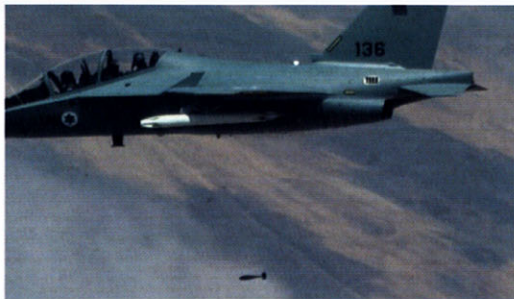
Un M-346 israeliano sgancia una bomba da esercitazione BDU-33. Sotto l'ala un pod lanciarazzi da addestramento SUU-5003 capace di quattro razzi CRV7 e, inferiormente, dieci bombe da esercitazione.
