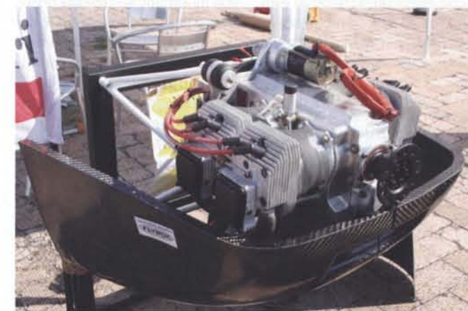
Europa Motori propone l'interessante conversione Jabiru 85 hp "firewall forward" per il Tecnam P92
