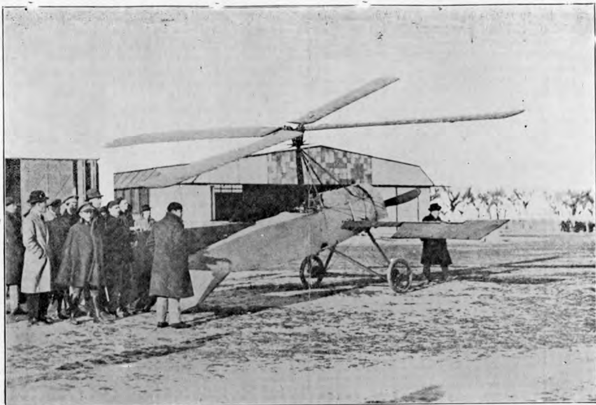
El Autogiro "La Cierva" que recientemente alcanzó una altura de 80 pies en las pruebas que se llevaron a cabo en el Aeródromo de Cuatro Vientos. Madrid.
