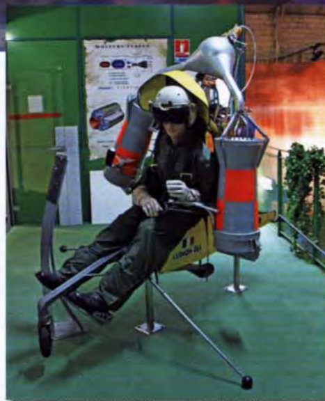
A sinistra: l'Aérospatiale SA-610 Ludion, un velivolo VTOL con motori basculanti del quale sono stati costruiti solo tre prototipi; questo è lo 003.
