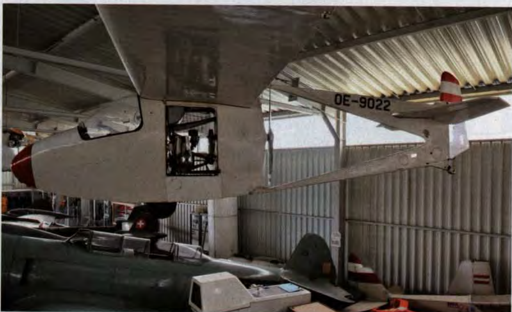
Il motoalante Raab Krähe V del 1958, con motore Steyr bicilindrico da 27 hp ed elica guidata da un albero di trasmissione
