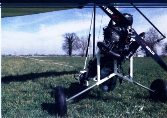
I puntoni laterali angolati ospitano il supporto sedile posteriore, le cinture sono a quattro punti con sgancio rapido
