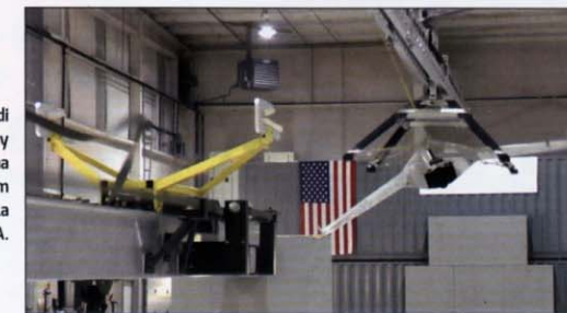
Un test di recupero del Fury con il sistema SideArm sviluppato dalla DARPA.
