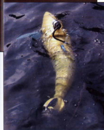
Il BIOSwimmer nella sua configurazione quasi definitiva. Mancano ancora le finestrate per i sensori elettroottici che, comunque, saranno facili da ricavare nella carena rigida anteriore. Sotto: il "tonno robot" può muoversi sia impiegando la silenziosa elica intubata, sia muovendo la coda come un pesce per la massima furtività.
