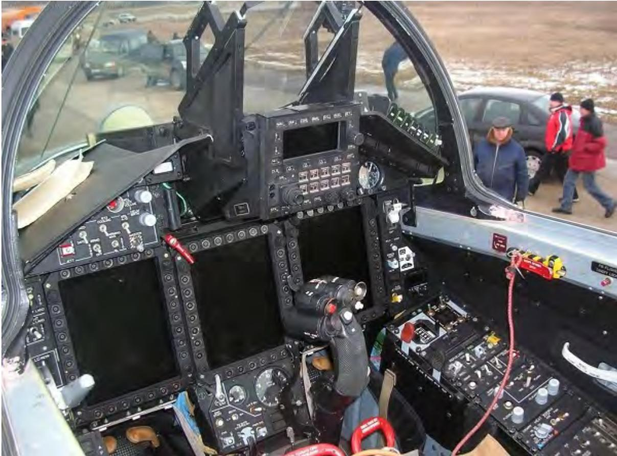
Le MiG-35 dispose du radar actif à balayage électronique (AESA) Zhuk-MAE (Zhuk-AE pour l'exportation) d'une portée de 130 à 200km pouvant traquer une trentaine de cibles et en engager 8. L'avion met en œuvre les derniers systèmes d'armes russes, dont les missiles R-77 et K-74M. La charge militaire avoisine maintenant les 6 tonnes. En matière d'avionique le pilote dispose d'un cockpit tout glace avec 4 écrans couleur LCD.
