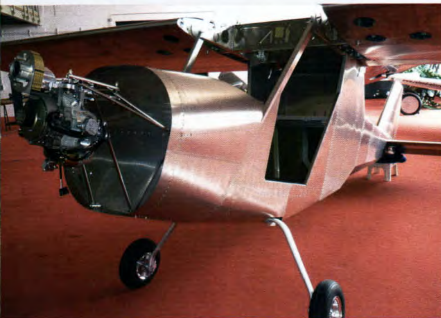
Il prototipo prima versione, con le balestre carrello piuttosto alte
