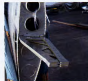
La baionetta alare sul longherone principale, tutti i componenti sono ricavati da lastre piane lavorate
