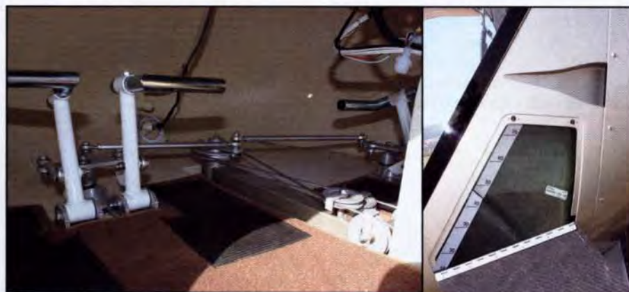
La pedaliera regolabile comanda anche il ruotino anteriore
