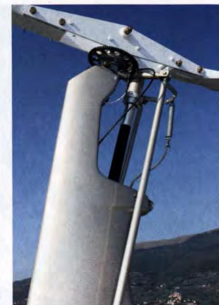
La nuova carenatura del mast e del flessibile di prerotazione
