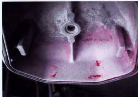
L'esame con liquidi penetranti ha evidenziato difetti di pressofusione con trasudamento di olio
