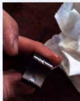
Evidente l'interferenza dei frammenti con grave asporto di materiale che è andato in circolo
