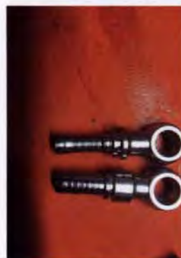
Il raccordo deformato (in alto) a confronto con il raccordo originale
