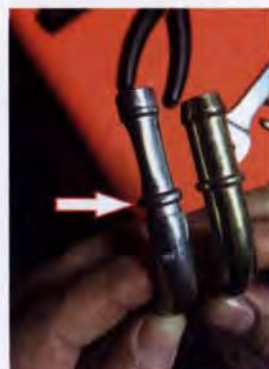
Ancora un raccordo deformato e fessurato (freccia) a confronto con l'originale
