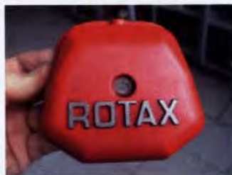
Il coperchio valvole apparentemente integro
