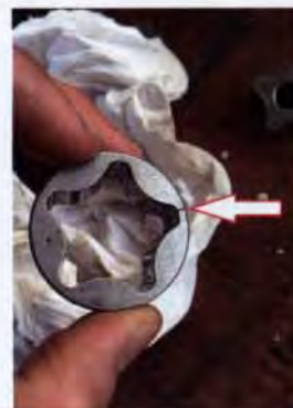
La rottura del trocoide della pompa
