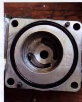
Il corpo pompa visibilmente rovinato dai pezzi metallici del raccordo
