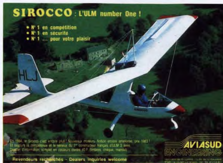
1984: una pagina pubblicitaria dell'Aviasud Sirocco con ala controventata in cavi e spoiler alari
