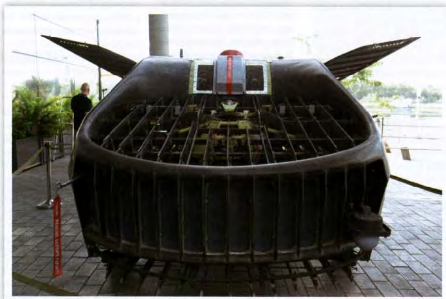
Le ventole di sostentamento dell' AirMule sono intubate e protette da griglie.
