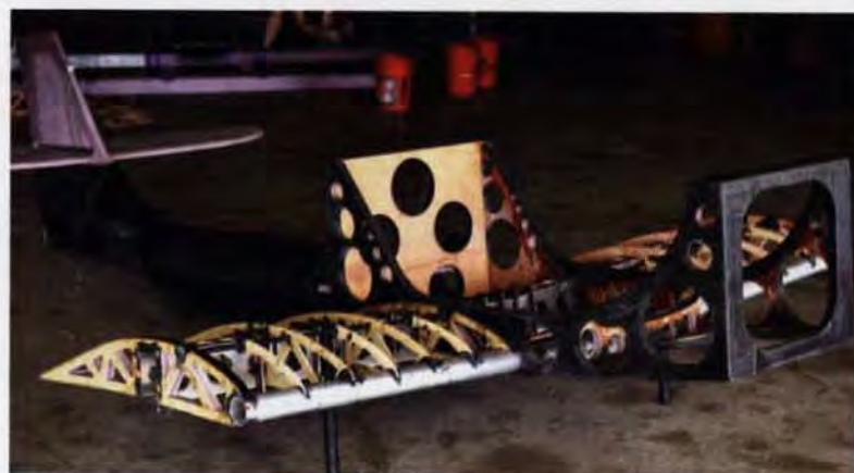
La struttura dello Skydock è mista in legno, alluminio e carbonio, il kit escluso il motore costa 4.000 $
