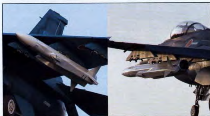
Il sistema di propulsione IRR (Integral Rocket Ramjet) vede l'integrazione di un razzo booster convenzionale con uno statoreattore.
