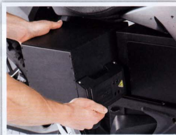
La sostituzione dei moduli batteria richiede meno di un minuto. Accanto: Lo spartano cruscotto, dotato di leve anziché di pulsanti, è pensato per essere sempre efficiente, persino se ricoperto di sabbia o fango.
