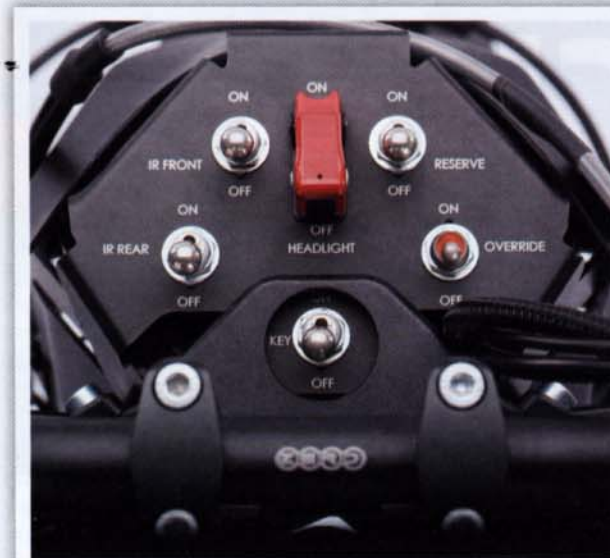
La sostituzione dei moduli batteria richiede meno di un minuto. Accanto: Lo spartano cruscotto, dotato di leve anziché di pulsanti, è pensato per essere sempre efficiente, persino se ricoperto di sabbia o fango.
