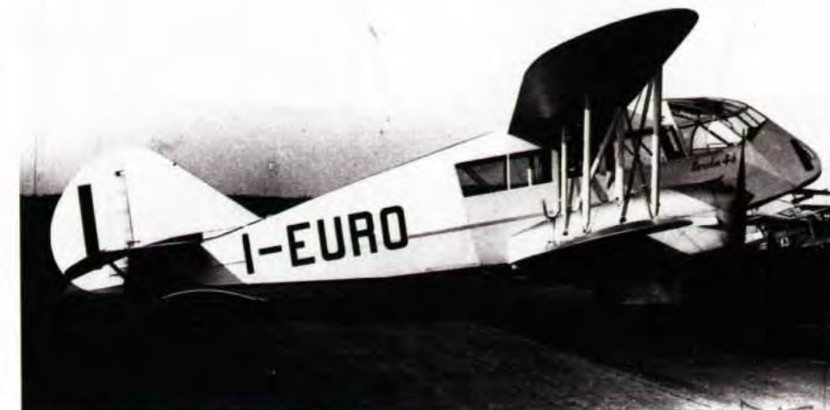
I-EURO dopo la modifica: motori De Havilland Gipsy Queen da 185 hp in posizione ribassata sull'ala
