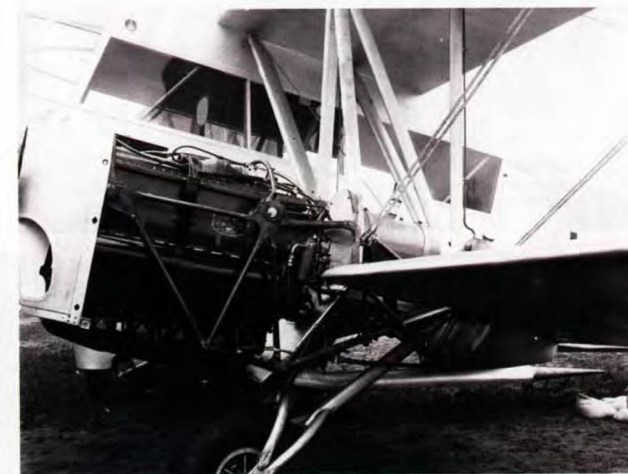
L'installazione del Gipsy Queen a cilindri invertiti migliorava notevolmente l'aerodinamica
