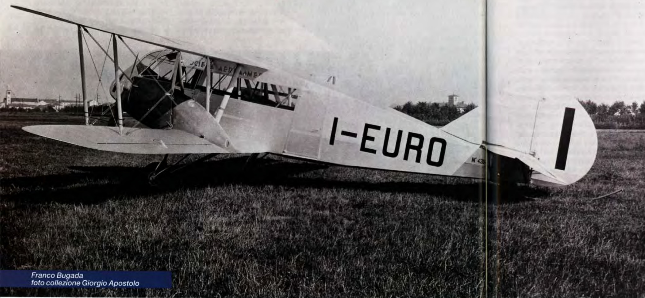
Il Breda 44 I-EURO nella prima versione con i motori completamente sopra l'ala
