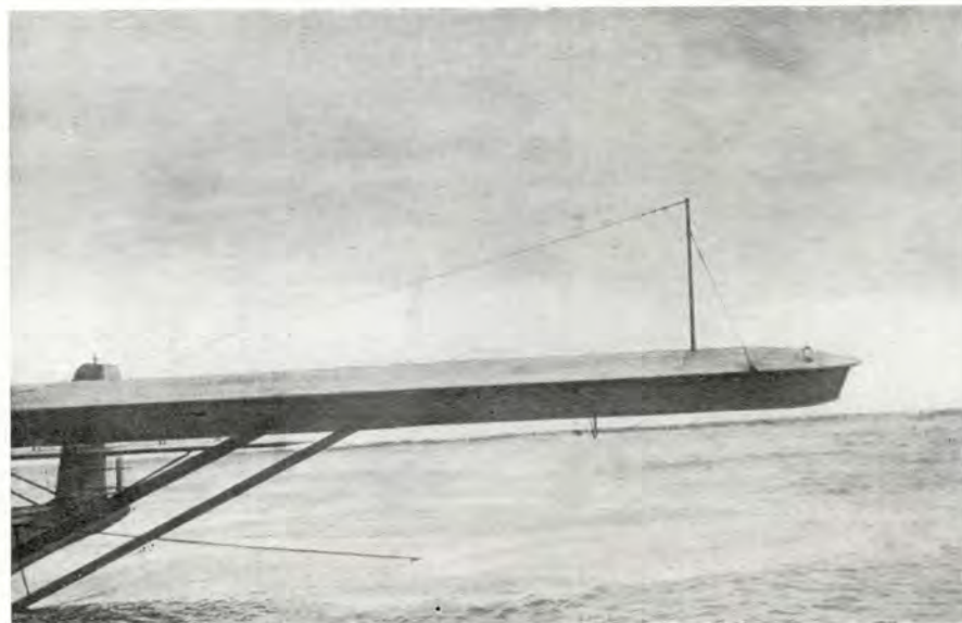
Particolare del supporto d'aereo fisso applicato sull'ala di un idrovolante Dornier Wall. - Fig. 2
