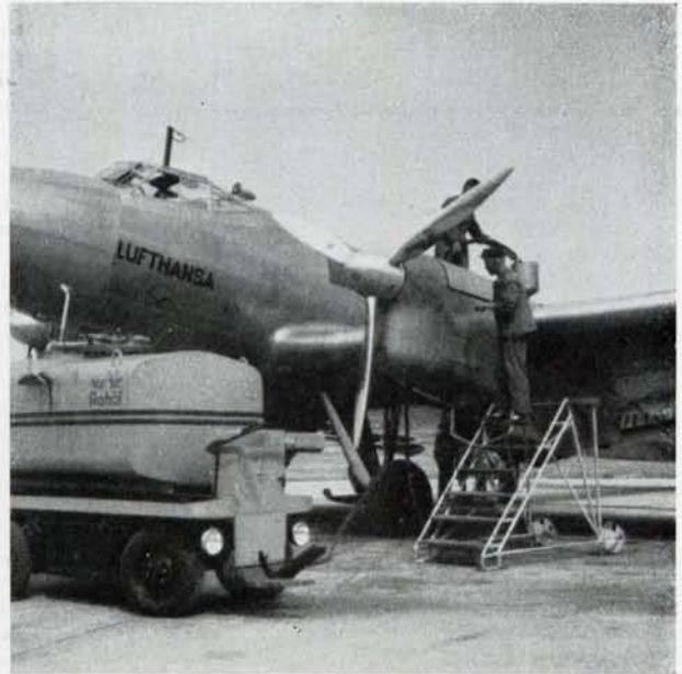
Betanken eines Dieselmotors im Luftverkehr
