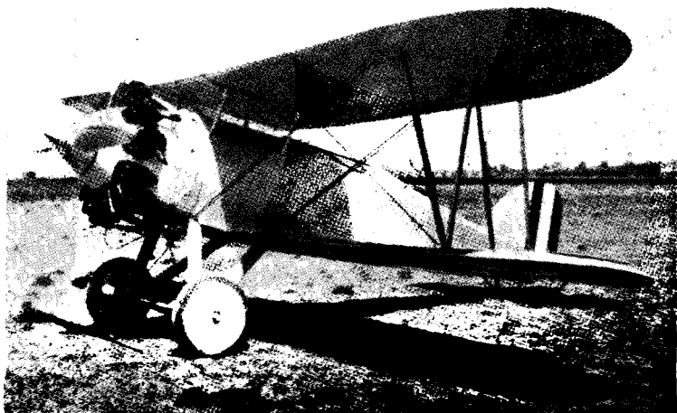
FIG. 3. — Il motore « Wasp » durante le prove di volo sul monoposto da caccia « Apache » della Marina degli S. U.
