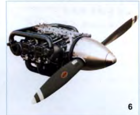
Fig. 42 - Il primo ed unico motore Diesel da aviazione che abbia volato in Italia è stato costruito dal nostro Stabilimento. Anno 1929 - 200 HP a 1600 giri/T. 3
