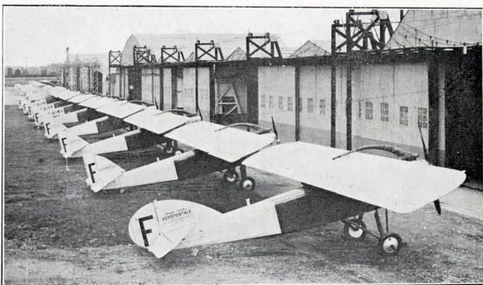
Une série d'avions postaux LATÉCOËRE 26, moteur RENAULT 450 HP. Noter, sur le premier appareil, le nouvel empennage et le gouvernail de direction avec volet correcteur.
