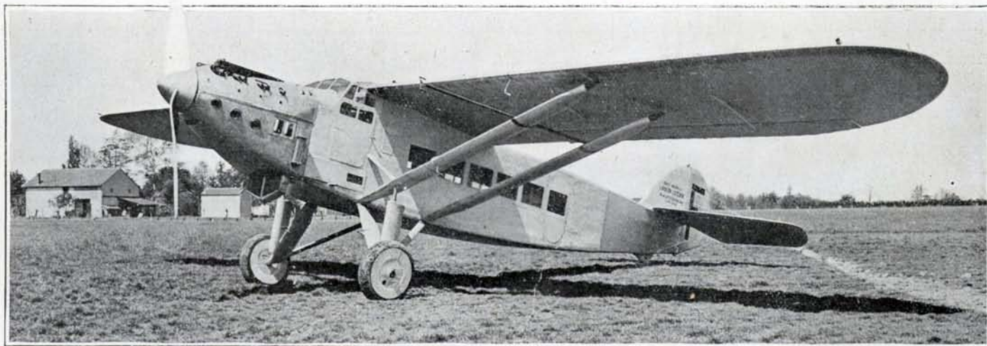
Le nouvel avion LATÉCOËRE 28, à moteur HISPANO-SUIZA 500 HP, pour le transport des passagers.
