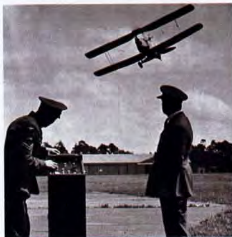
Il Queen Bee controllato con la console a terra, l'assenza di alettoni richiedeva molta attenzione nelle manovre a bassa quota
