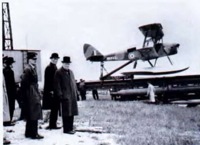
Il Queen Bee controllato con la console a terra, l'assenza di alettoni richiedeva molta attenzione nelle manovre a bassa quota
