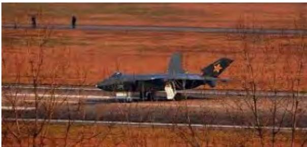
E' più grosso soprattutto per trasportare più carburante, con una quantità stimata in 25.000 libbre contro le 18.000 del caccia Lockheed, il che si traduce con un raggio di combattimento fenomenale, non dichiarato ma sicuramente superiore ai 760 km dell'aereo americano col solo carburante interno.
