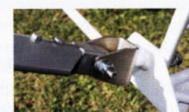
L'attacco inferiore dei montanti consente di ruotarli lungo la fusoliera per il trasporto senza le semiali
