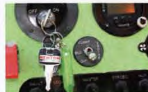
Una semplicissima levetta a tre posizioni controlla l'intero ciclo della turbina
