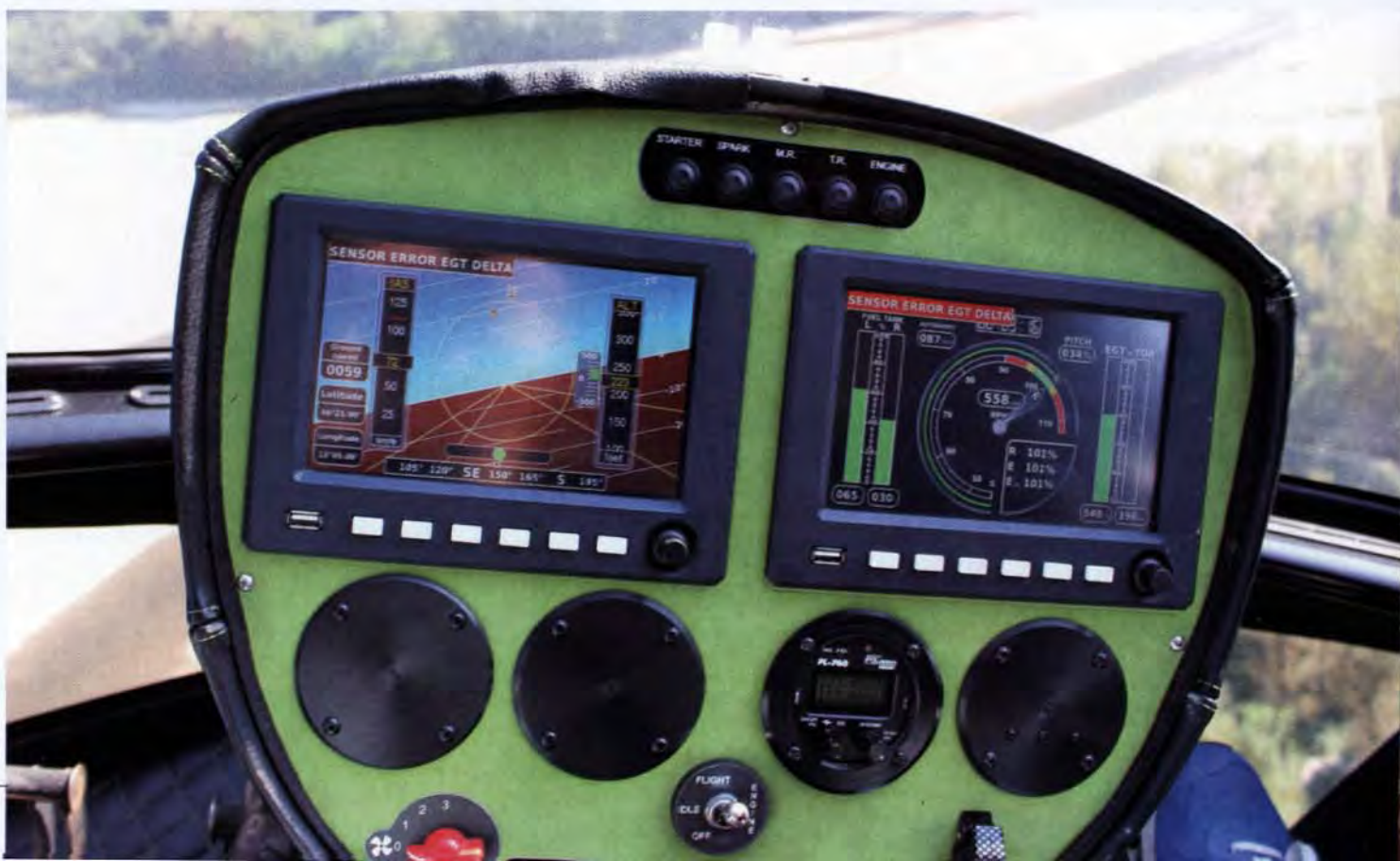
Il pannello con l'EFIS a sinistra e, a destra, la pagina di controllo del motore
