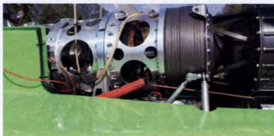
Il motore installato open air è perfettamente ispezionabile
