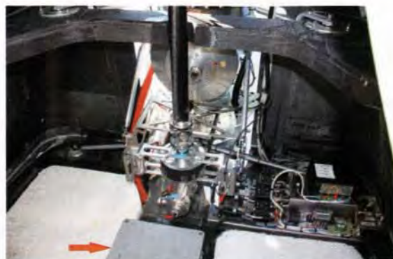
Un portello consente di ispezionare la trasmissione e la cinghia, la freccia indica la batteria al litio da 88V
